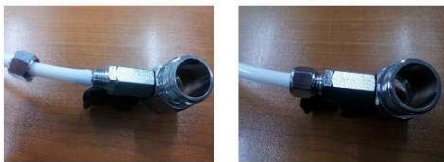
Рис. 2. - Соединение полиуретанового шланга с водопроводным краном
