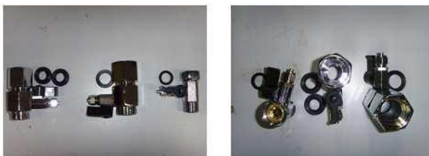
Рис. 2. - Соединение полиуретанового шланга с водопроводным краном
