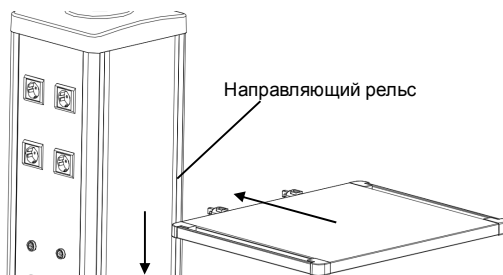
Рисунок 3-14. Установка быстро монтируемой полки
