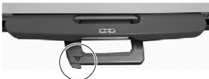
Кнопка тормоза блока со сменным детектором с не вращающимся кассетодержателем
