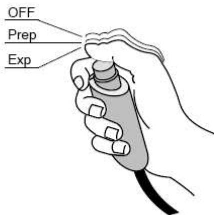
Рентгенографический снимок также может быть выполнен с помощью ручной кнопки снимка, которая подключена к пульту управления.
