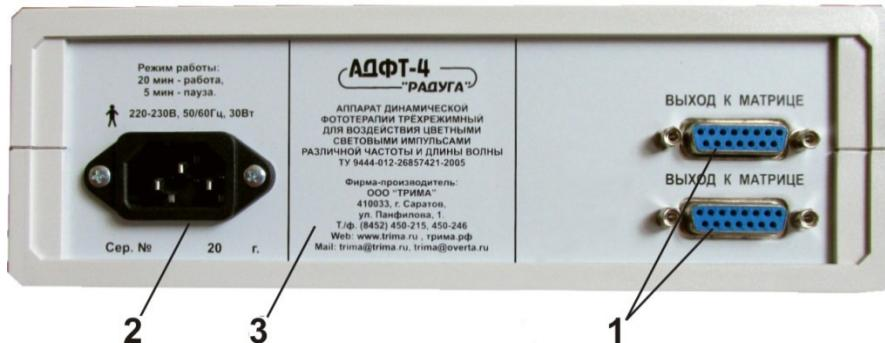
Рис. 4. Задняя панель электронного блока аппарата.
