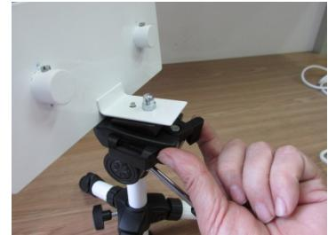
При необходимости угловое положение узла поворота и фиксации матриц может быть отрегулирована с помощью поворотной ручки на стойке. Затем на поверхность узла устанавливаются светодиодные матрицы, так же как и на ложементы старой стойки.
