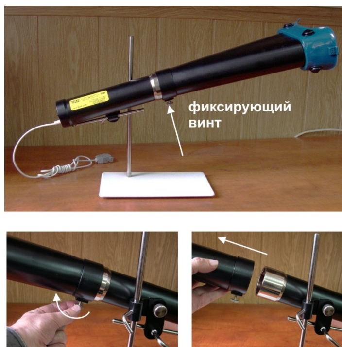
Рис.6. Снятие дополнительного тубуса с приставки.
