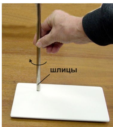
Рис.4. Установка стойки в основание.
