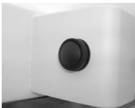
Рисунок 4.7 – Кнопка тормоза блока с держателем или с постоянно установленным детектором
