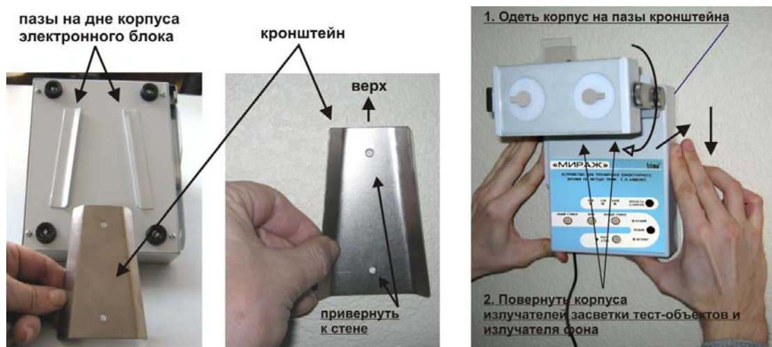
Рис.9. Установка устройства "МИРАЖ" на стене.
