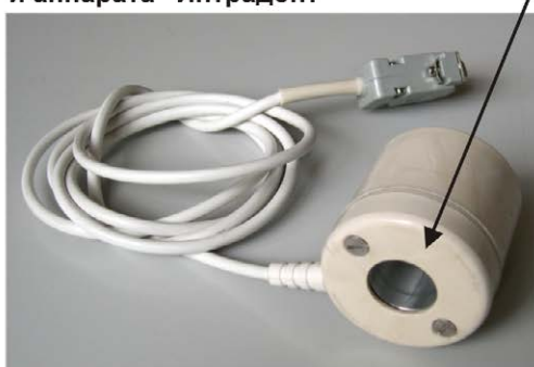
Рис. 4. Излучатель бегущего магнитного поля аппарата "АМО-АТОС".
