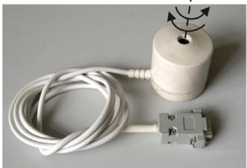
Рис. 4. Излучатель бегущего магнитного поля аппарата "АМО-АТОС".
