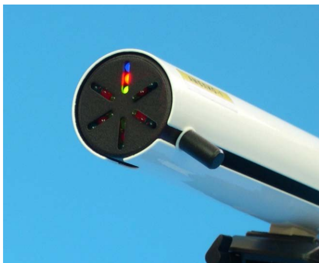
Рис.6. Излучатель динамических фотостимулов приставки "АМБЛИО-1".
