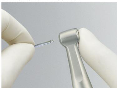
Кнопочный зажим – оригинальный механизм от NSK с автоматическим зажимным патроном, который усиливает фиксацию бора во время вращения. Зажим обеспечивает установку и извлечение бора одним нажатием кнопки без каких-либо дополнительных инструментов. Механизм зажима бора разработан таким образом, что сила удержания бора увеличивается при возрастании скорости.
