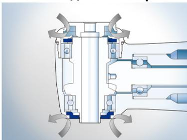
Уникальная система двойной герметизации от NSK предотвращает попадание крови и ротовой жидкости в головку наконечника, обеспечивая долгий срок службы инструмента.
